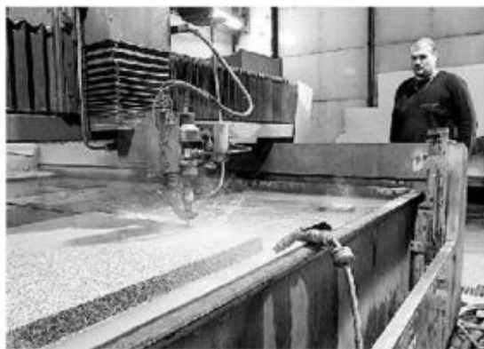
S PŘESNOSTÍ. Technika řezání vodním paprskem získává na oblibě. S přesností až na 0,1 mm nařeže i kamenné desky. Foto: archiv P. Kallus
